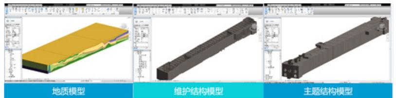
银湖地铁项目 5D BIM 技术主要以 Revit2013 建模软件和 RIB iTWO 为平台。完成了土方、围护结构和主体结构的建模，通过 iTWO 的多专业碰撞检测，共发现图纸 9 处问题，项目部及时与设计院沟通解决，保证了项目图纸的准确性，避免了不必要的返工。
